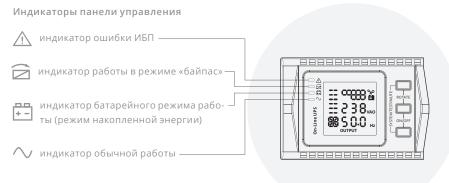
Рисунок 5. Панель управления ИБП
