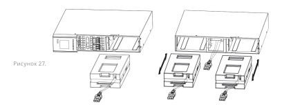
4. Возьмите новый комплект аккумуляторных батарей за его среднюю часть и вставьте его в отсек ИБП или ВБМ. После установки нового комплекта аккумуляторных батарей необходимо убедиться в том, что он полностью попал на полозья шасси, как это показано на рисунке 28.
