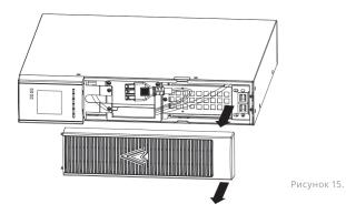
2. Снимите направляющие для проводов в нижней части передней крышки ИБП.
